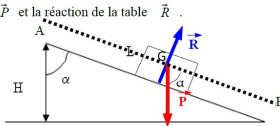
2-b) Le travail de la réaction de la table est nul car la direction de cette force est perpendiculaire à la direction du mouvement.
